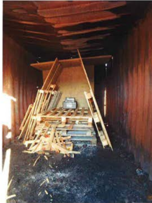
Photo 7: Mise en place du coffre dans le caisson. Source CEREN 2015
