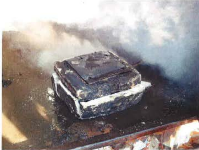
Photo 12: Etat extérieur du coffre après l'essai. Source CEREN 2015
